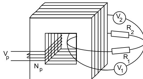
Finn spenningen som avleses på de to voltmetrene  $V_1$  og  $V_2$ . Voltmetrene er i modus for å måle vekselspenning.
