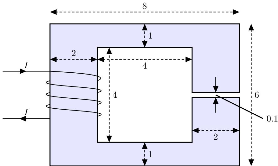
Figuren over viser en jernkjerne med alle mål gitt i cm. Kjernens tykkelse (vinkelrett på papirplanet) er 1cm. Anta at den magnetiske fluksstettheten  $\mathbf{B}$  er jevnt fordelt over alle tverrsnittsareal  $S$  av kjernen, slik at  $\Phi = \int_S \mathbf{B} \cdot d\mathbf{S} \approx BS$ . Kjernen har en relativ permeabilitet på 5000. Det er  $N = 100$  viklinger, og strømmen  $I$  er 1mA.
