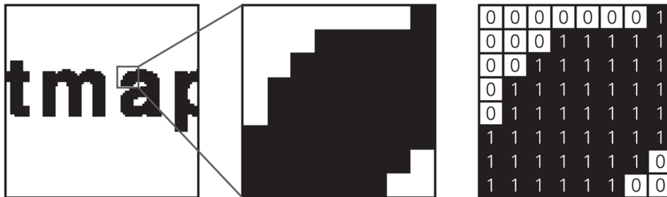
Figur 1.2. Forstørret skjermbilde med ordet “bitmap” og tilhørende bit-er for hvert pixel (Picture Element)
