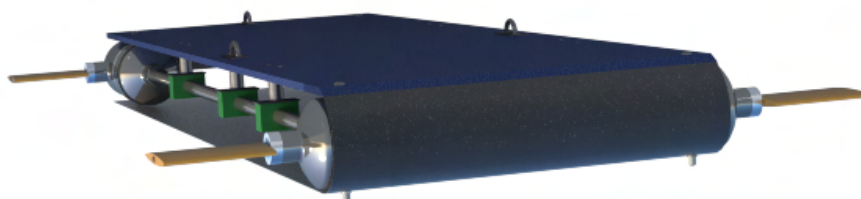
Figur 90: Fiberduk trekt over ROV-en sin underside, og ben med gummiknotter skrudd til akslene som senterer motorbrakett.
