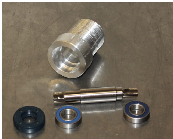
Figur 92: Resultat av motoraksel og akselgjennomføring
