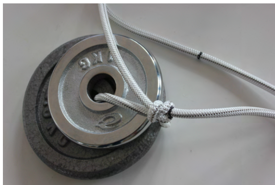
Figur 98: Oppsett for test av forlengelse.
