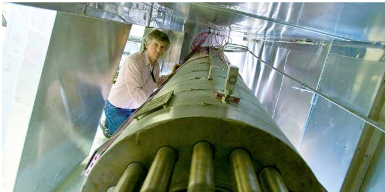
Under: Rolf Johannessen ved SINTEF IKT i trykktank hvor elektronikk i instrumenteringssystem testes ut.
