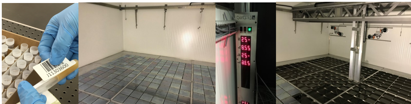
Figur 3. Barkoding (strekkode) av prøveglassene, innsiden av selve fryseboksen og robotarmen som løfter opp stativene med prøver ("prøverackene").
