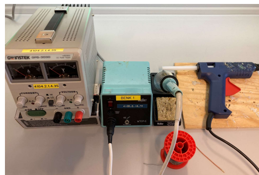
Figur 4: Felles teststasjon med strømforsyning, loddebolt og limpistol.
