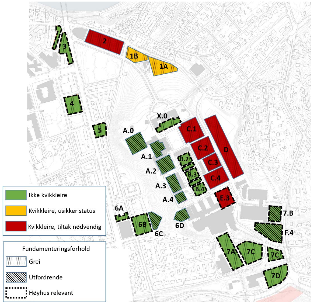
Figur 4 Innledende geoteknisk vurdering av alternativer
