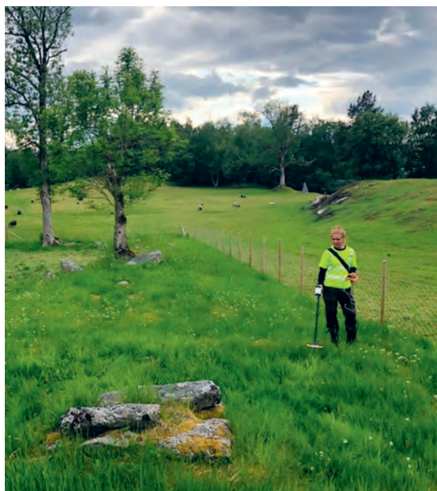
Figur 1. Siri Torkehagen gjør målinger av magnetisk susceptibilitet på Veøy. Foto: Arne A. Stamnes, NTNU Vitenskapsmuseet.
