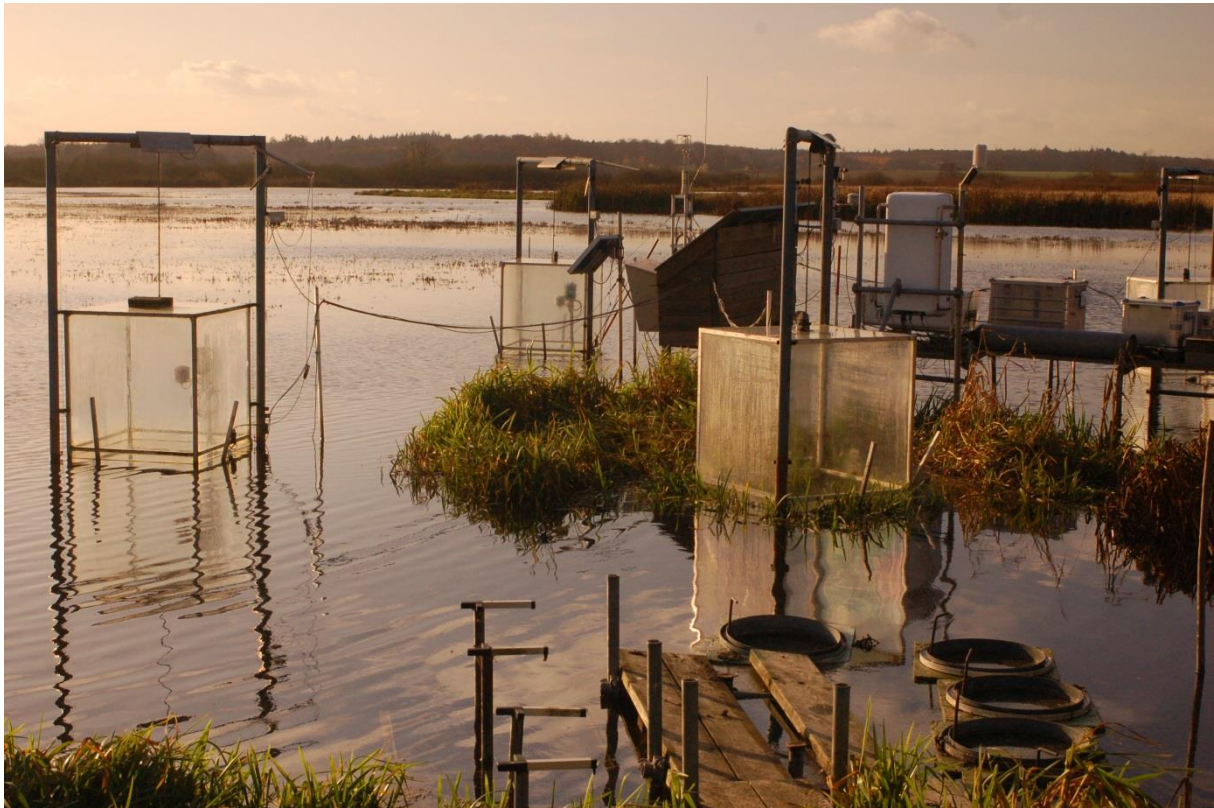
Figur 14. Automatiserte målinger i lukket kammer i et område i Peenetal (Tyskland) som restaureres ved rewetting. Transparente, dynamiske lukka kamre heves og senkes automatisk og regelmessig gjennom døgnet, og målingene gjøres også automatisk. Foto: Hans Joosten.
