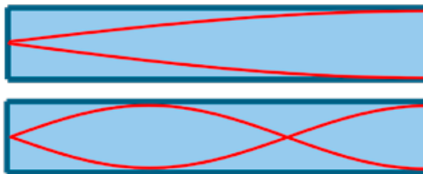
Figur 2. Figuren viser de to lengste stående bølger som kan oppstå i et rør med en lukket og en åpen ende. De røde linjene viser trykkprofilen i røret for første (øverste rør) og tredje (nederste rør) harmoniske komponent. Andre harmoniske komponent finnes ikke i halvåpne rør.
